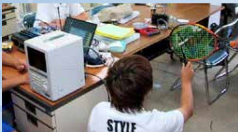
図1 テニスラケットの振動解析
