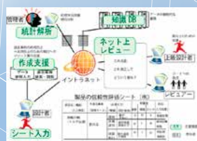
図3 Webベースの故障解析・リスク評価データベース
