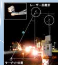
図5 汎用レーザー距離計を用いた道路雪氷情報の計測
