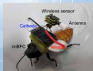
図3 昆虫を用いた無線センサロボット
