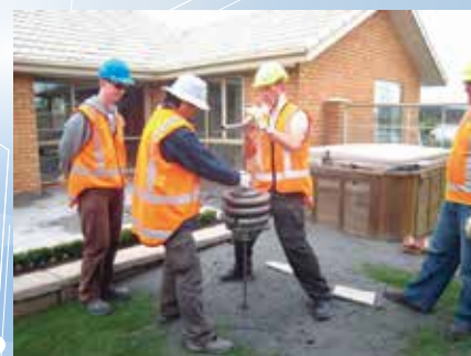
図4 海外での液状化地盤調査
