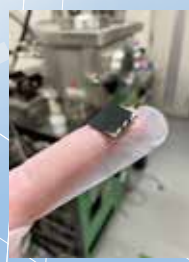
図5 真空プロセスを用いて作製した硫化物薄膜
