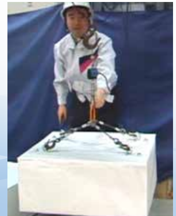
図3 指一本で重量物を搬送できるパワーアシストクレーン (200kgの荷物も指一本で搬送可能)
