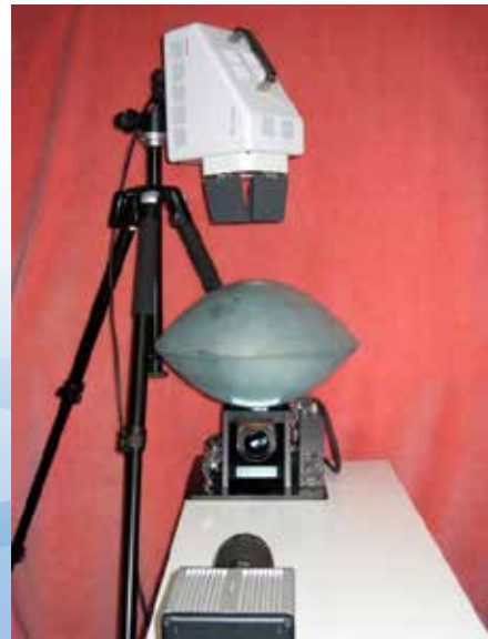
図2 光学走査型360°多視点動画撮影システム
