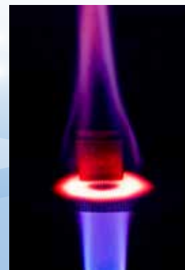
図2 木質バイオマス試料 (燃焼試験中)
