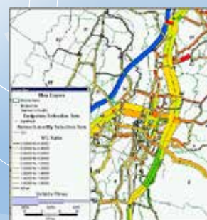
図2 交通需要予測モデルによる交通配分結果 (TransCAD)
