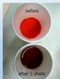
図1 パルス大強度相対論的電子ビーム照射による水環境汚染化学物質の分解 (上: 照射前, 下: 照射後)
