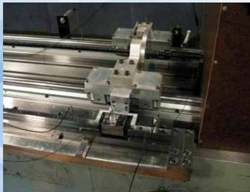
図1 振動とアコースティック・エミッションによるリニアガイドウェイの傷の検出
