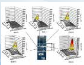
図1 レーザによるSPCC/A5052異種金属接合における界面温度分布の熱伝導解析
