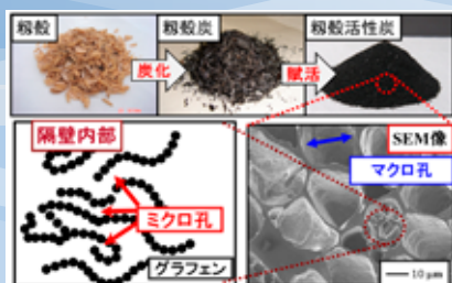
図3 高い水素吸蔵能力を有する 籾殻由来の活性炭 (ナノポーラスカーボン)
