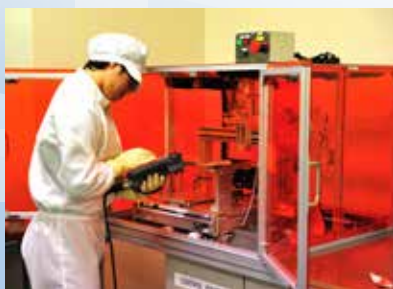
図2 液晶分子配向印刷機（スリットコーター）
