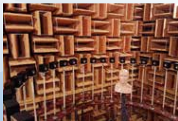
図1 無響室での音響特性試験
