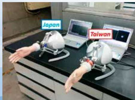
図2 日本・台湾をインターネットで結ぶ遠隔握手ロボット (日本と台湾で互いに握手の動きを伝え合う)
