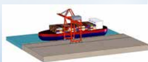
図2 港湾コンテナクレーンの風環境下解析用バーチャルシミュレータ
