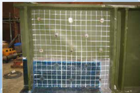
図2 炭素繊維シート接着工法の確立に向けた実験
