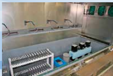
図2 腐食促進試験機
