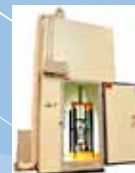
図5 雪氷のトライボロジー特性解析用低温室および環状せん断特性実験解析システム
