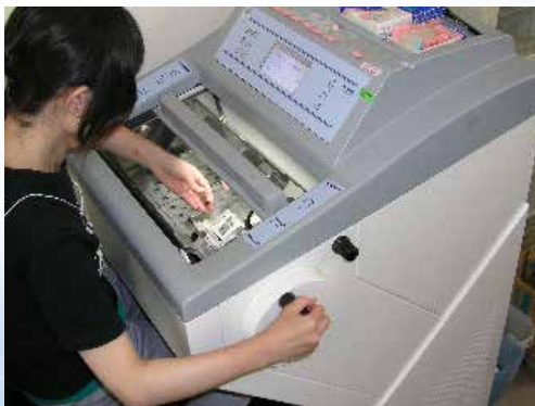
図1 クリオスタットを用いてマウス脳の切片を作製しているところ。
