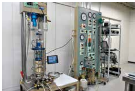
図1 局所ひずみ測定三軸試験装置
