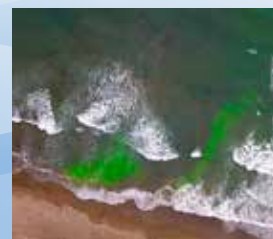
図2 可視化した離岸流 （緑色が着色した離岸流、UAVで撮影）
