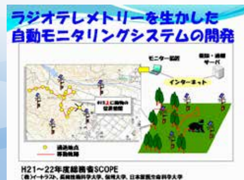
図2 野生動物との共生のための動物専用周波携帯を利用したリアルタイムモニタリングシステム
