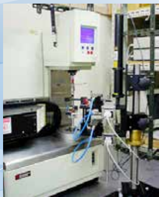
図1 フルイド・スペクトロメーターおよび光学異方性測定装置
