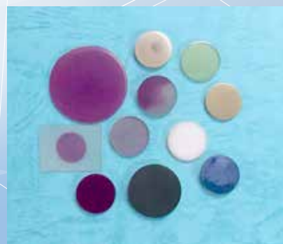
図2 放電プラズマ焼結により作製した各種焼結体。セラミックスや金属、複合材料など、何でも固めます！
