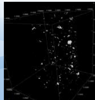
図2 X線CTによるセラミックス中の傷の評価
