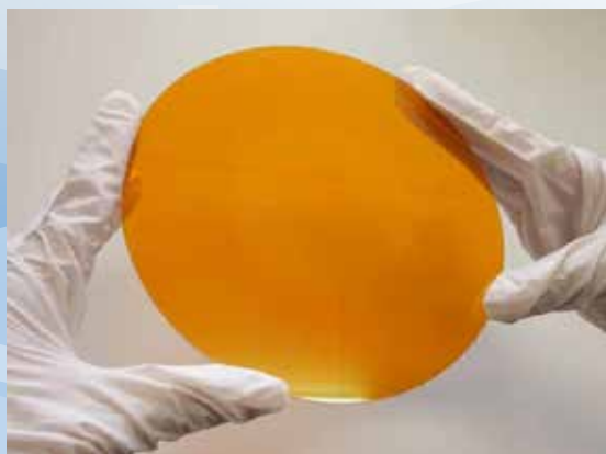
図1 開発した直径15cmの磁気光学測定用ガーネット膜
