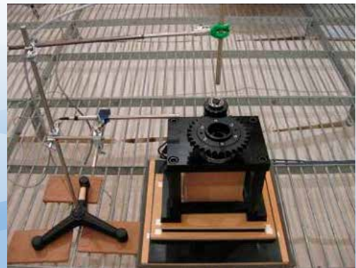
図2 無響室でのトロコイド歯車の騒音測定
