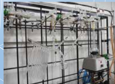
図3 完全禁水下での重合に用いる高真空ライン
