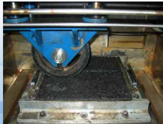
図2 ホイールトラッキング試験によるアスコンの耐流動性評価
