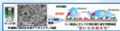
図2 高機能生体親和性界面のイメージ図。体内へインプラント等の材料を埋入した際、材料へタンパク質吸着と細胞接着が起こり、界面形成されます。この形成メカニズムを解明することにより、高機能な生体親和性材料が創製できます。 [代表論文: Tagaya M., Kobunshi Ronbunshu, 70, 398 (2013).]
